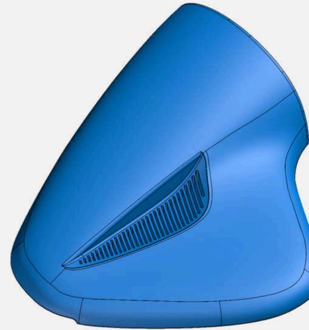
Tangentenstetige Flächenrückführung aller Freiformflächen im gewünschten CAD-Format.
